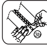
Paso 3b. Retire las láminas de protección de una en una. Alise cuidadosamente la película delgada a medida que se retira cada una de las láminas de protección.
